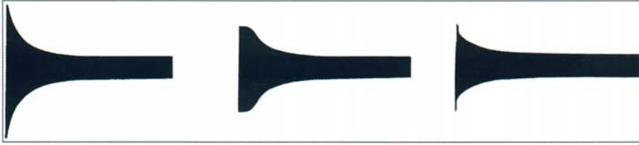
Abb. 3: Interaktion zwischen Limiter und Kompressor im A-Mod-Betrieb; links: Um 12 dB abgesenktes Burstsinal mit langer Attackzeit; Mitte: Das gleiche Burstsinal mit aktiviertem Peak Limiter; rechts: gleiches Signal mit aktivierter A-Mod-Funktion.
